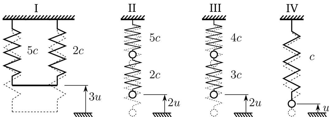
Sortieren Sie die gespeicherten potentiellen Energien  $E_I$ ,  $E_{II}$ ,  $E_{III}$  und  $E_{IV}$  der in ausgelenkter Lage dargestellten Systeme nach der Größe, indem Sie die zugehörigen Indizes in die Ungleichung unten eintragen.
