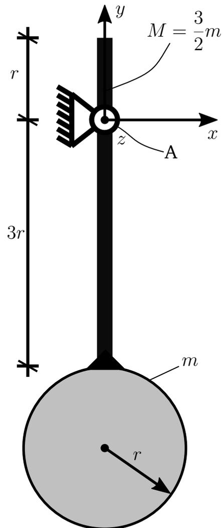
Eine Scheibe (Masse  $m$ , Radius  $r$ ) ist fest mit einem Stab (Masse  $M = \frac{3}{2}m$ , Länge  $4r$ ) verbunden, der eine Länge  $3r$  von der Scheibe entfernt am Lager A befestigt ist. Berechnen Sie das Massenträgheitsmoment  $\Theta_A$  des Gesamtkörpers bezüglich der  $z$ -Achse des gegebenen Koordinatensystems.
