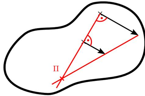
Zeichnen Sie die Momentanpole  $\Pi$  der folgenden Walzen ein, die jeweils mit der Winkelgeschwindigkeit  $\omega$  rotieren. Die linke und die mittlere Walze sind gelenkig gelagert. Die rechte Walze rollt auf einer Oberfläche, ohne zu rutschen.
