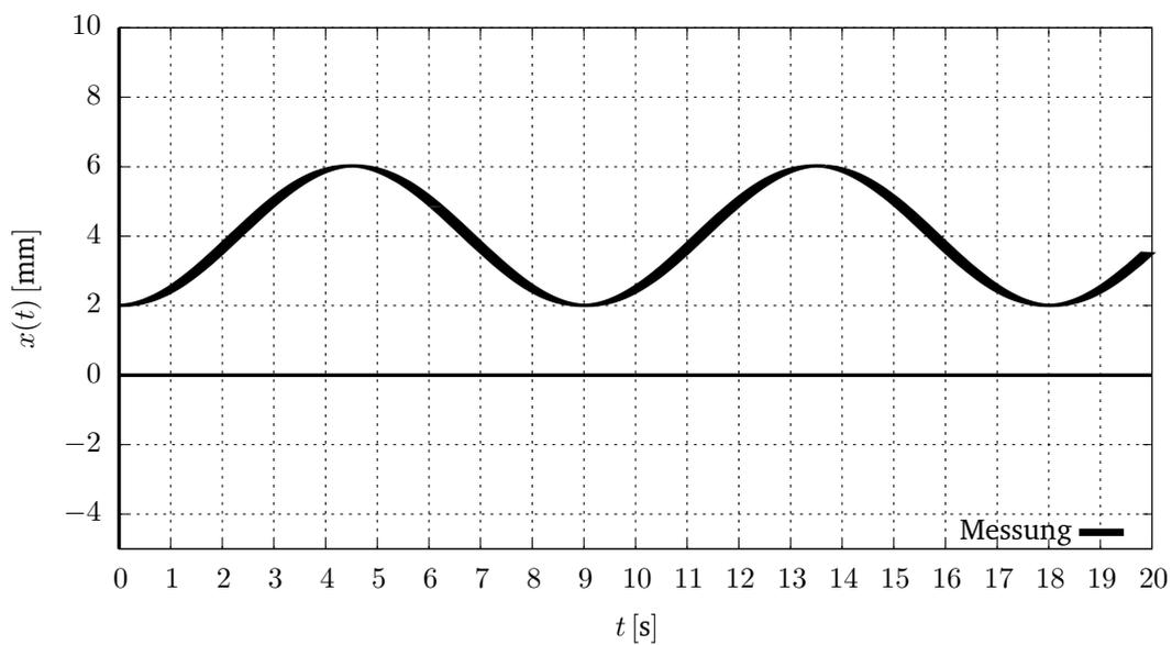
Für eine harmonische Schwingung wurde das oben dargestellte Signal gemessen. Geben Sie für diese Schwingung die Amplitude in mm, den Phasenwinkel in rad, die Periodendauer in s und die Frequenz in Hz an.
