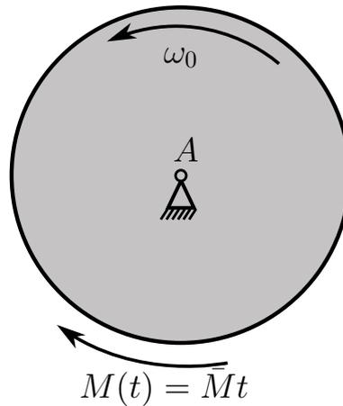
Eine Walze (Massenträgheitsmoment  $\Theta_A$ ) rotiert mit der Winkelgeschwindigkeit  $\omega_0$  um den gelagerten Mittelpunkt  $A$ . Das System wird von außen durch das sich zeitlich verändernde Moment  $M(t) = \bar{M}t$  gebremst.
