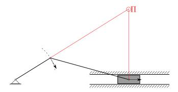
b) Markieren Sie für das folgende System die Lage des Momentanpols der Stufenwalze mit den Radien R und r. Zeichnen Sie darüber hinaus den Geschwindigkeitsvektor des Punktes  $\boxed{\mathbb{P}}$  ein und geben Sie dessen Betrag in Abhängigkeit von  $v_1$ , R und r an.
