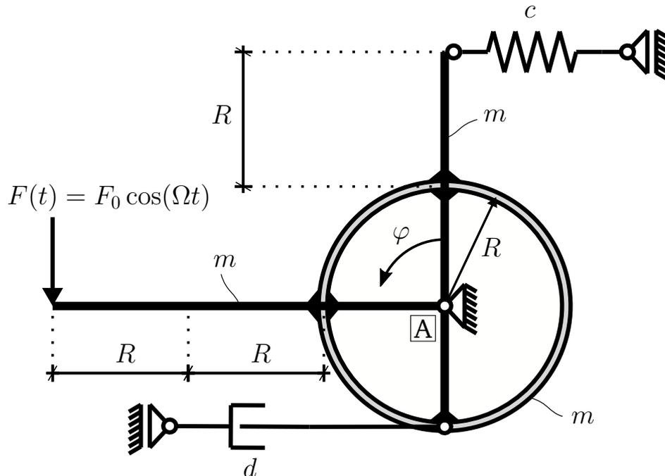
Ein Ring (Masse  $m$ , Radius  $R$ ) und zwei Stäbe (beide Masse  $m$ , Länge  $l = 3R$ ) sind fest miteinander verbunden und drehen sich zusammen um den Punkt **A**. Am System ist eine Feder (Federsteifigkeit  $c$ ) sowie ein Dämpfer (Dämpfungskonstante  $d$ ) befestigt. Das System wird durch eine periodische Kraft  $F(t) = F_0 \cos(\Omega t)$  angeregt.  $\varphi = 0$  beschreibt die Ruhelage des Systems ohne Erregung.
