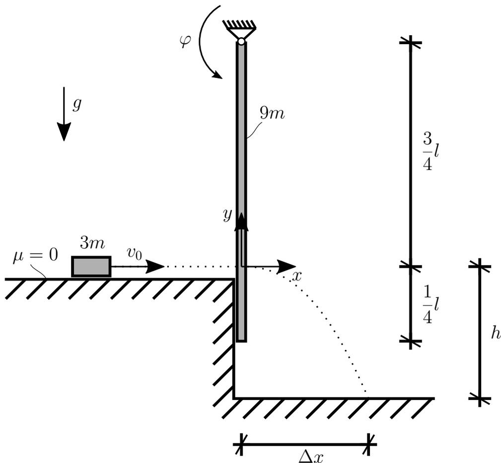
Eine Kiste (Masse  $3m$ ) gleitet reibungsfrei auf einer Ebene und stößt (Stoßzahl  $e$ ) mit der Geschwindigkeit  $v_0$  gegen einen ruhenden Stab (Länge  $l$ , Masse  $9m$ ) in einem Abstand von  $\frac{3}{4}l$  von dessen Lager. Nach dem Stoß fällt die Kiste eine Stufe (Höhe  $h$ ) hinunter. Bei diesem freien Fall kann der Luftwiderstand vernachlässigt werden.
