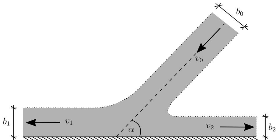
In einer horizontalen Ebene trifft ein Flüssigkeitsfreistrahler unter dem Winkel  $\alpha$  mit einer Geschwindigkeit  $v_0$  auf einer Wand auf. Die Tiefe des Strahls  $h$  sei konstant.
