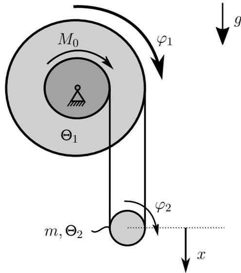
Ein Seil wird mit zwei fest verbundenen Seiltrommeln (Gesamtmassenträgheitsmoment  $\Theta_1$ ) abgerollt. Am Seil hängt eine drehbare Rolle (Masse  $m$ , Massenträgheitsmoment  $\Theta_2$ ).
