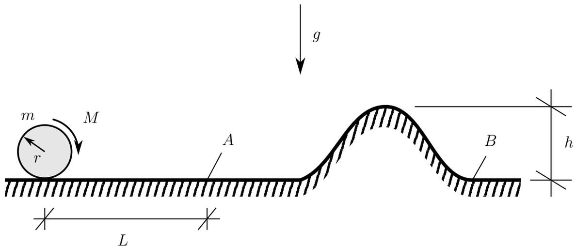
Eine in der Ausgangslage ruhende, homogene Walze (Masse  $m$ , Radius  $r$ ) wird durch ein konstantes Moment  $M$  angetrieben. Nachdem die Walze die Strecke  $L$  zurückgelegt hat, entfällt das Moment. Zudem wird davon ausgegangen, dass zwischen der Ausgangslage der Walze und dem Punkt  $A$  kein Rutschen auftritt.
