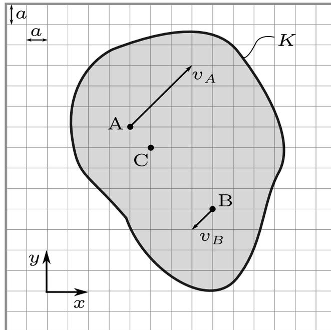
Der Körper  $K$  bewegt sich in der Ebene, wobei in den Punkten A und B die Geschwindigkeiten  $v_A = 3v$  und  $v_B = v$  gemessen werden.
