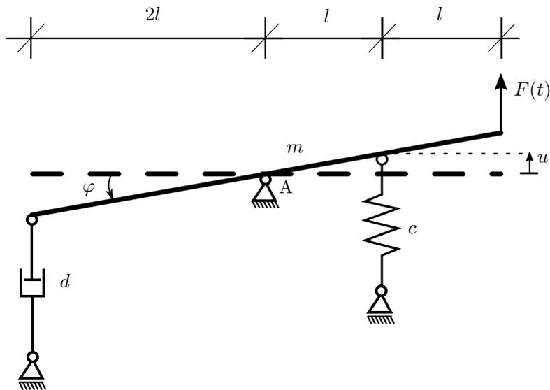
Das skizzierte System besteht aus einem homogenen, starren Balken (Masse  $m$ ), einem Dämpfer (Dämpfungskonstante  $d$ ) und einer Feder (Federkonstante  $c$ ). Am rechten Ende des Balkens wirkt die zeitabhängige Kraft  $F(t)$ . Die gestrichelt dargestellte Lage ist die statische Ruhelage des Systems, für welche die Feder entspannt ist. Die Auslenkungen des Systems sind klein.
