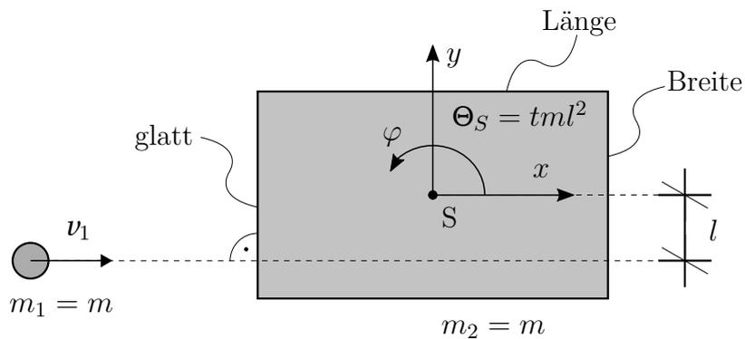
In der Ebene stößt (Stoßzahl  $e$ ) eine Punktmasse  $m_1$  ( $m_1 = m$ ) senkrecht mit einer Ausmitte  $l$  gegen eine glatte, homogene, rechteckige Scheibe (Masse  $m_2 = m$ , Schwerpunkt  $S$ , Massenträgheitsmoment  $\Theta_S = tml^2$ ). Die Scheibe befindet sich vor dem Stoß in Ruhe.
