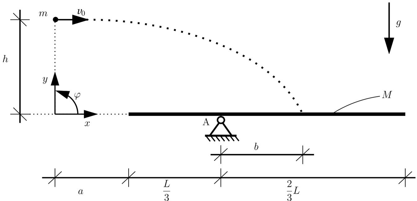
Eine Punktmasse (Masse  $m$ ) wird aus der Höhe  $h$  horizontal mit der Geschwindigkeit  $v_0$  im Erdschwerefeld losgeworfen. Am Ende des Wurfs stößt die Punktmasse auf einen homogenen, starren Stab (Masse  $M = 5m$ , Länge  $L$ ). Zum Zeitpunkt des Stoßes befindet sich der Stab in Ruhe. Die Stoßzahl ist  $e$ . Der Stoß ist glatt.
