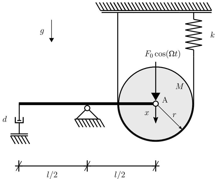
Eine homogene Scheibe (Masse  $M$ , Radius  $r$ ) ist in A drehbar an einem masselosen, starren Balken befestigt. An dessen anderem Ende befindet sich ein Dämpfer mit der Dämpfungskonstante  $d$ . Über die Scheibe wird ein masseloses, dehnstarres Seil geführt, an dessen Ende sich eine Feder mit der Federkonstanten  $k$  befindet. Rutschen zwischen Seil und Scheibe ist ausgeschlossen.
