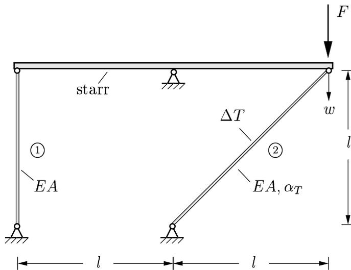
Das abgebildete Tragwerk besteht aus einem starren Balken und zwei elastischen Stäben.
