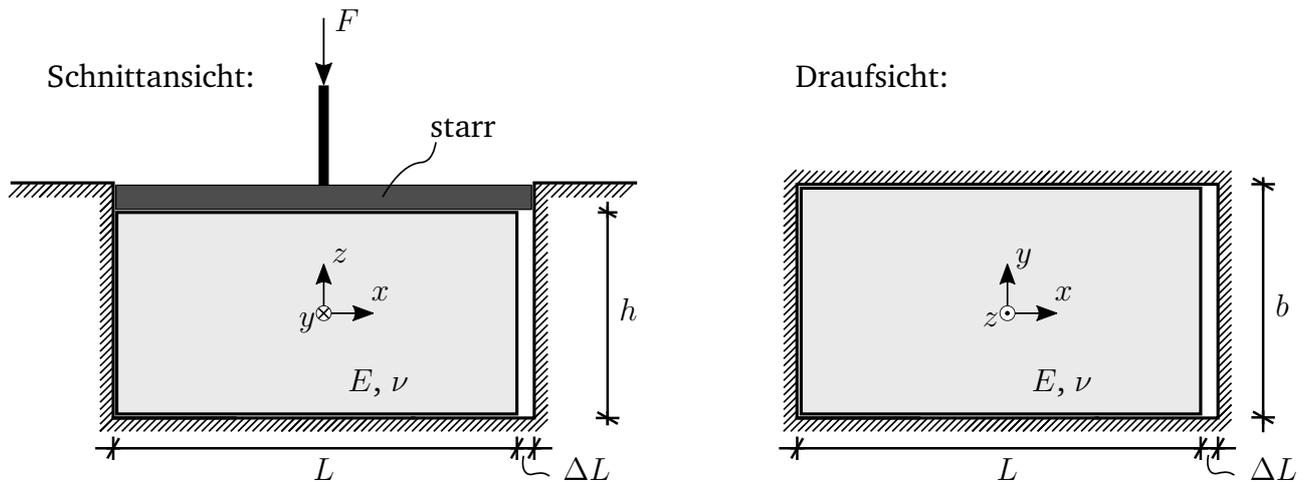
Ein gewichtsloser Quader (Elastizitätsmodul  $E$ , Querdehnungszahl  $\nu$ ) ist in eine um  $\Delta L$  zu lange Öffnung eingelassen, deren Ränder als starr und glatt (Reibkoeffizient  $\mu = 0$ ) angenommen werden können. Im dargestellten Zustand ist der Quader spannungsfrei.
