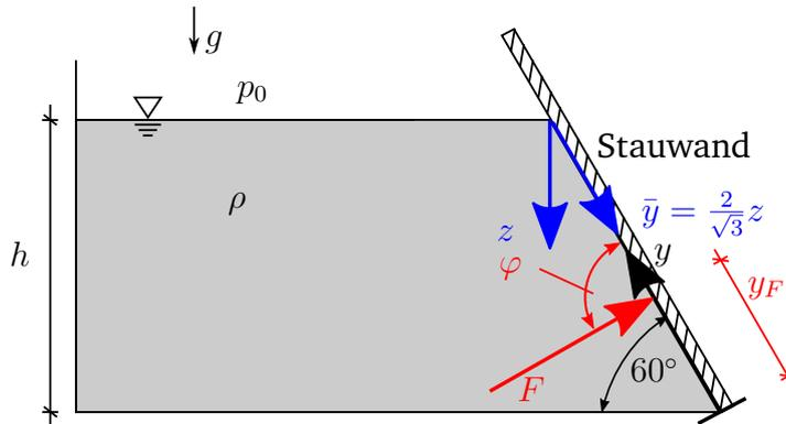
Der skizzierte Behälter mit der Tiefe  $t$  (dritte Raumrichtung) wird durch eine Stauwand abgegrenzt. Er ist bis zur Höhe  $h$  mit einer Flüssigkeit der Dichte  $\rho$  gefüllt. Der Umgebungsdruck kann vernachlässigt werden ( $p_0 = 0$ ).
