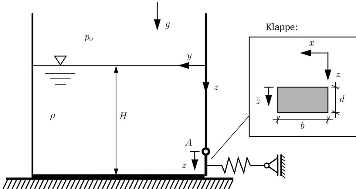
Ein offener Behälter ist bis zur Höhe  $H$  mit einer Flüssigkeit der Dichte  $\rho$  gefüllt. An der rechten unteren Seite besitzt der Behälter eine um  $A$  drehbare, rechteckige Klappe (Breite  $b$ , Höhe  $d$ ), die mit einer vorgespannten Feder (Federkraft  $F_c = 4\rho g b d^2$ ) geschlossen gehalten wird. Die Feder ist im Mittelpunkt der Klappe angebracht.
