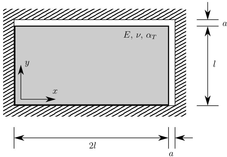
Die dargestellte rechteckige Scheibe wird in einen starren Ausschnitt eingesetzt. Dieser ist in beiden Richtungen um  $a$  größer als die Scheibe. Es wird angenommen, dass zwischen dem Ausschnitt und der Scheibe keine Reibung herrscht und ein ebener Spannungszustand ( $\sigma_z = \tau_{xz} = \tau_{yz} = 0$ ) vorliegt. Die Scheibe wird um  $\Delta T$  erwärmt.
