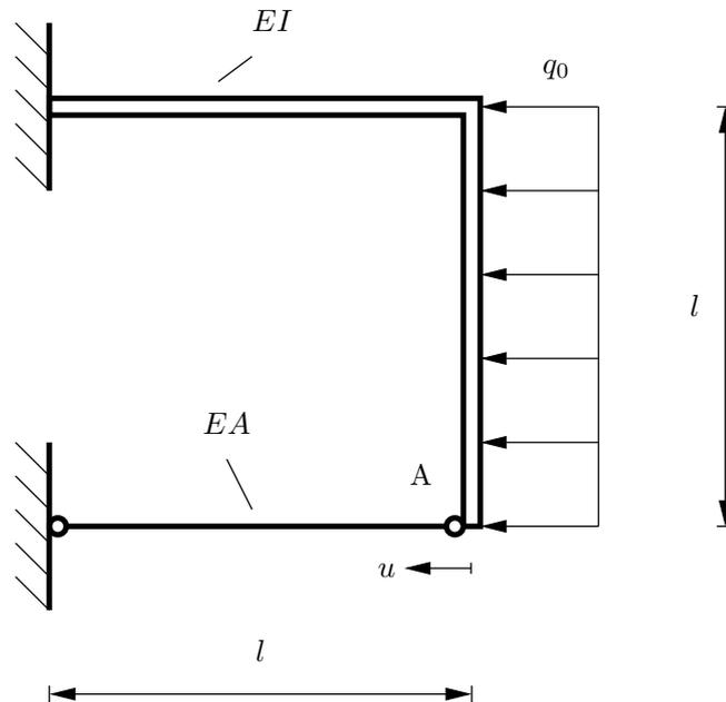
Der abgebildete dehn- und schubstarre Rahmen (Biegesteifigkeit  $EI$ ) wird durch eine konstante Streckenlast  $q_0$  belastet und durch einen Stab (Dehnsteifigkeit  $EA$ ) unterstützt.
