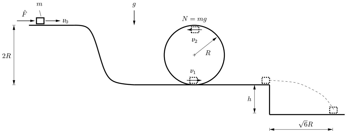
Eine Punktmasse (Masse  $m$ ) wird aus der Ruhelage mit der Stoßkraft  $\hat{F}$  angestoßen und gleitet reibungsfrei auf einer Unterlage. Die Punktmasse tritt mit der Geschwindigkeit  $v_1$  in einen Looping ein. Am oberen Punkt wird die Geschwindigkeit  $v_2$  erreicht und die Normalkraft zwischen Bahn und Punktmasse soll  $N = mg$  betragen.
