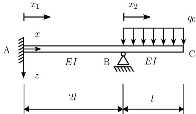
Dargestellt ist ein System, bestehend aus einem dehn- und schubstarren Balken (Länge  $3l$ , Biegesteifigkeit  $EI$ ). Im Punkt A ist der Balken fest eingespannt und im Punkt B ist der Balken in vertikaler Richtung gelagert. Der rechte Teil des Balkens (zwischen Punkt B und C) ist durch die abgebildete, konstante Streckenlast  $q_0$  belastet.
