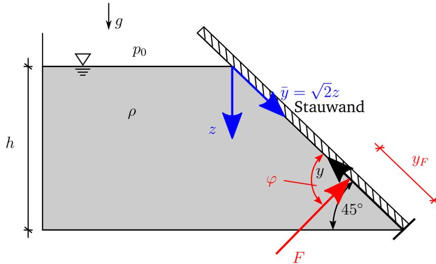
Der skizzierte Behälter mit der Tiefe  $t$  (dritte Raumrichtung) wird durch eine Stauwand abgegrenzt. Er ist bis zur Höhe  $h$  mit einer Flüssigkeit der Dichte  $\rho$  gefüllt. Der Umgebungsdruck kann vernachlässigt werden ( $p_0 = 0$ ).
