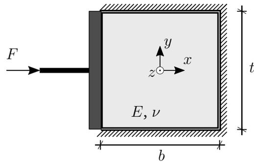
Ein gewichtsloser Quader (Elastizitätsmodul  $E$ , Querdehnungszahl  $\nu$ ) ist in eine passgenaue Öffnung eingelassen, deren Ränder als starr und glatt (Reibkoeffizient  $\mu = 0$ ) angenommen werden können. Im dargestellten Zustand ist der Quader spannungsfrei. Über den Stempel wird der Quader mit Hilfe der Kraft  $F$  nun so weit zusammengedrückt, dass er sich in  $z$ -Richtung genau bis zur oberen Kante ausdehnt (Erhöhung um  $\Delta h \ll h$ ).
