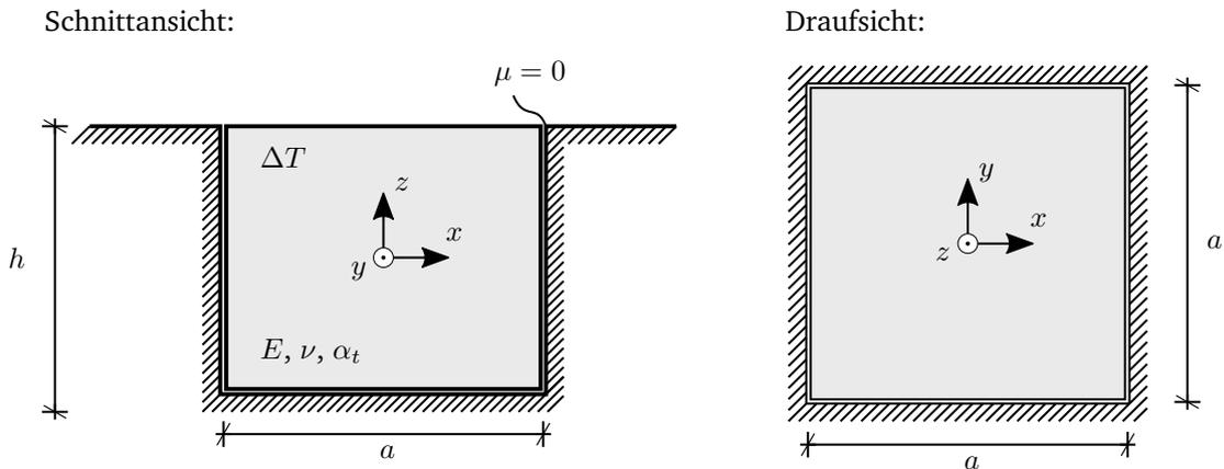
Ein gewichtsloser Quader (Elastizitätsmodul  $E$ , Querdehnungszahl  $\nu$ , Wärmeausdehnungskoeffizient  $\alpha_T$ ) ist in eine passgenaue Öffnung eingelassen, deren Ränder als starr und glatt (Reibkoeffizient  $\mu = 0$ ) angenommen werden können. Berechnen Sie die Spannung  $\sigma_x$  für eine Temperaturerhöhung von  $\Delta T = 100$  K.
