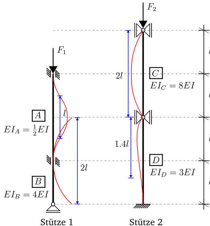
Die dargestellten Stützen 1 und 2 haben je Stützenabschnitt **A** - **D** konstante Biegesteifigkeiten. Die Stützenabschnitte sind unterschiedlich gelagert.
