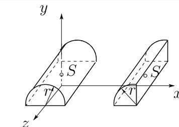
$S$  liegt in der Schnittgeraden der beiden Symmetrieebenen im Abstand  $y_S$  von der Auflagefläche
