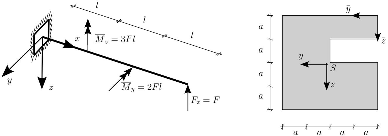
Der einseitig eingespannte Balken hat den dargestellten Querschnitt und ist durch eine Einzellast  $F_z = F$  und zwei Momente  $\bar{M}_z = 3Fl$  und  $\bar{M}_y = 2Fl$  belastet. Die Wirkungslinie der Einzellast verläuft durch den Schwerpunkt des Querschnitts.
