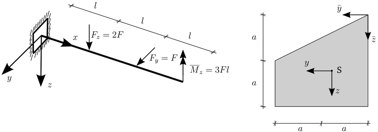
Der einseitig eingespannte Balken hat den dargestellten Querschnitt und ist durch zwei Einzellasten  $F_y = F$  und  $F_z = 2F$  und ein Moment  $\bar{M}_z = 3Fl$  belastet. Die Wirkungslinien der Einzellasten verlaufen durch den Schwerpunkt des Querschnitts.
