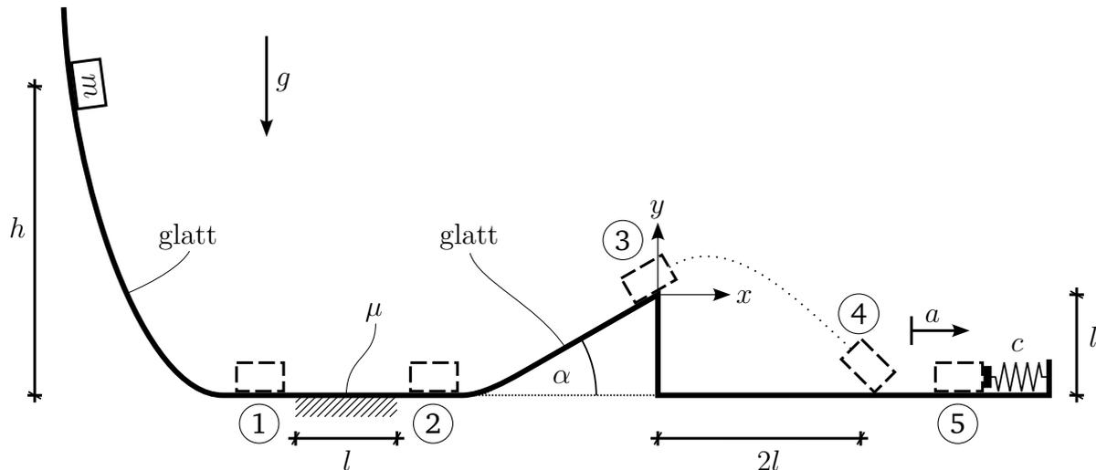
Eine Punktmasse (Masse  $m$ ) wird aus einer Höhe von  $h$  losgelassen und gleitet zunächst über eine glatte Bahn. Sie bewegt sich dann über einen rauen Abschnitt (Reibungskoeffizient  $\mu = \frac{1}{2}$ , Länge  $l$ ). Auf den rauen Abschnitt folgt eine glatte Rampe (Steigungswinkel  $\alpha = 30^\circ$ , Höhe  $l$ ). Nach der Rampe landet die Punktmasse wieder verlustfrei auf der glatten Bahn und rutscht gegen eine Feder (Federsteifigkeit  $c$ ).
