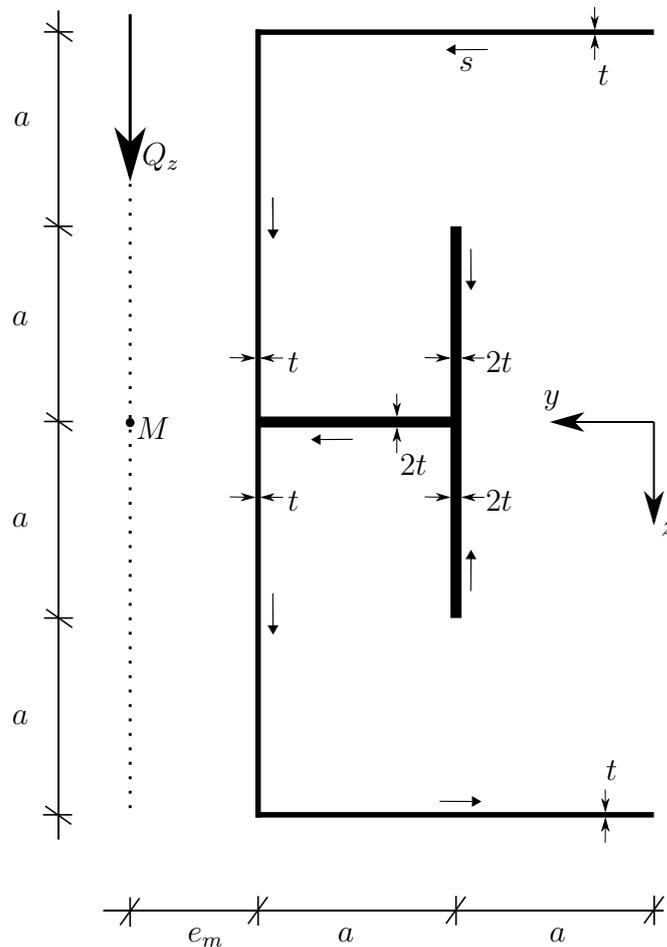
Der abgebildete dünnwandige, offene Querschnitt wird durch die Querkraft  $Q_z$  belastet, deren Wirkungslinie durch den Schubmittelpunkt  $M$  verläuft.
