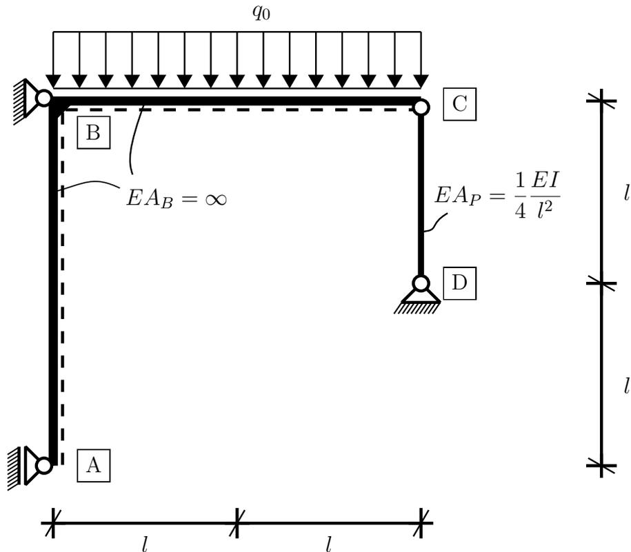
Die dargestellte dehn- und schubstarre Rahmenkonstruktion mit konstanter Biegesteifigkeit  $EI$  ist zusätzlich im Punkt  $\boxed{C}$  durch eine Pendelstütze gelagert, welche eine konstante Dehnsteifigkeit  $E A_P = \frac{1}{4} \frac{EI}{l^2}$  besitzt. Das Tragwerk wird durch eine konstante Streckenlast  $q_0$  belastet.
