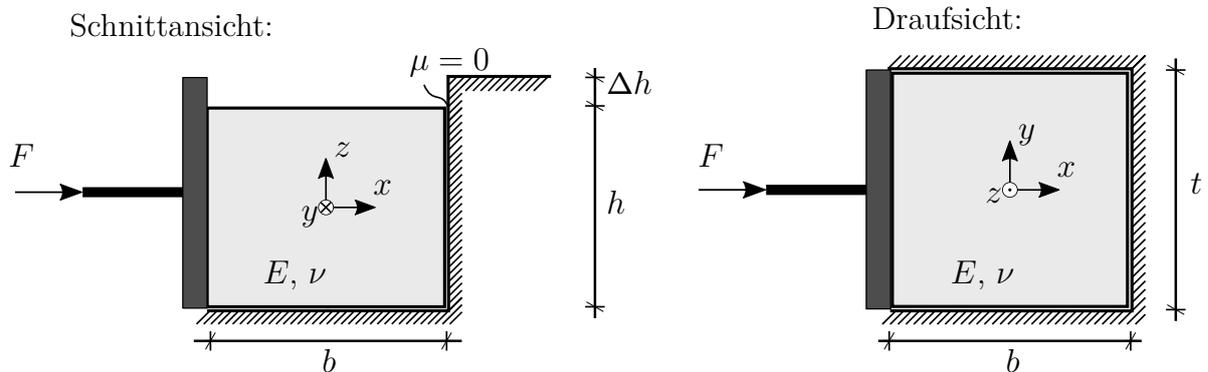
Ein gewichtsloser Quader (Elastizitätsmodul  $E$ , Querdehnungszahl  $\nu$ ) ist in eine passgenaue Öffnung eingelassen, deren Ränder als starr und glatt (Reibkoeffizient  $\mu = 0$ ) angenommen werden können. Im dargestellten Zustand ist der Quader spannungsfrei.
