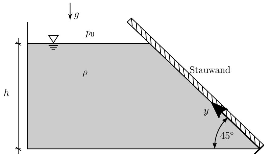
Der skizzierte Behälter mit der Tiefe  $t$  (dritte Raumrichtung) wird durch eine Stauwand abgegrenzt. Er ist bis zur Höhe  $h$  mit einer Flüssigkeit der Dichte  $\rho$  gefüllt. Der Umgebungsdruck kann vernachlässigt werden ( $p_0 = 0$ ).
