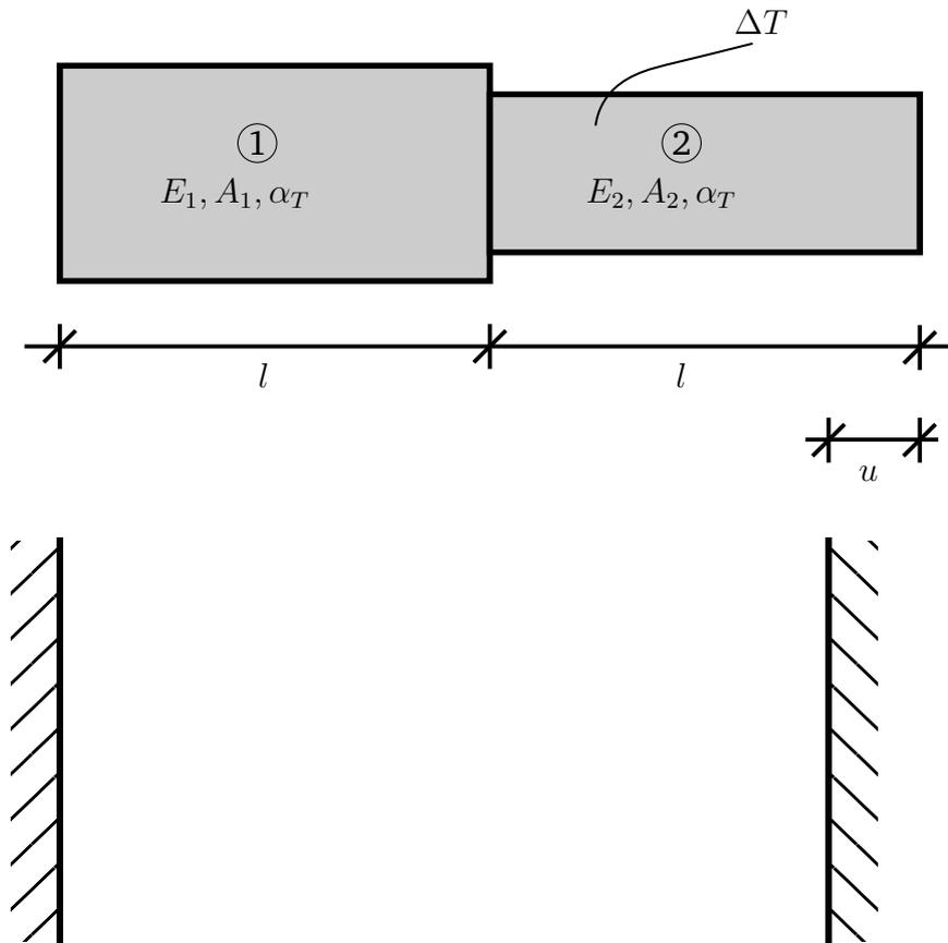
Der skizzierte Stab ist aus zwei Materialien (Dehnsteifigkeit  $E_i A_i$ , Wärmeausdehnungskoeffizient  $\alpha_T$ ) zusammengesetzt. Er soll durch Abkühlung des Abschnitts ② um  $\Delta T < 0$  in die Lücke der Länge  $2l - u$  eingepasst werden. Der Abschnitt ① kühlt dabei nicht ab.
