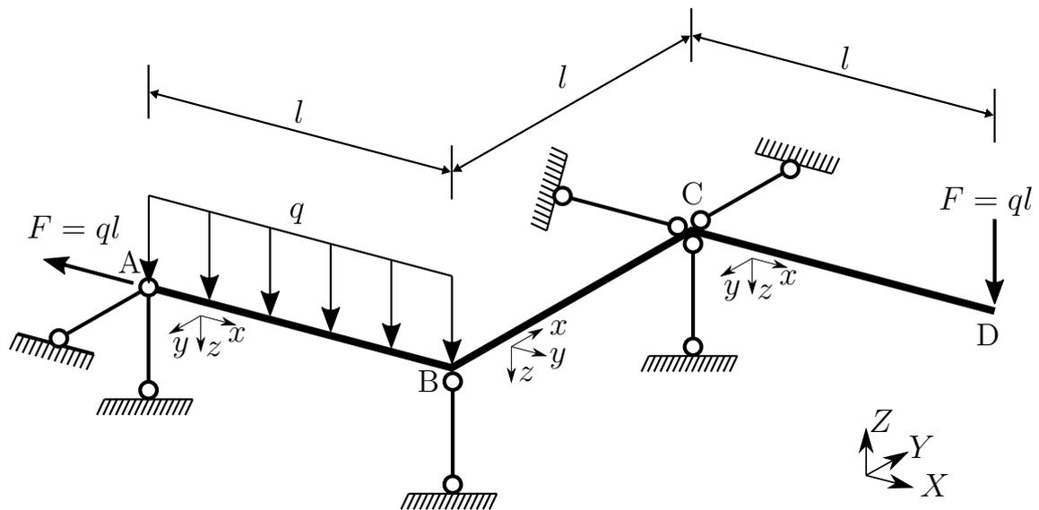
Das dargestellte räumliche, rechtwinklige Tragwerk ist durch die konstante Streckenlast  $q$  und zwei Einzellasten  $F = ql$  belastet.
