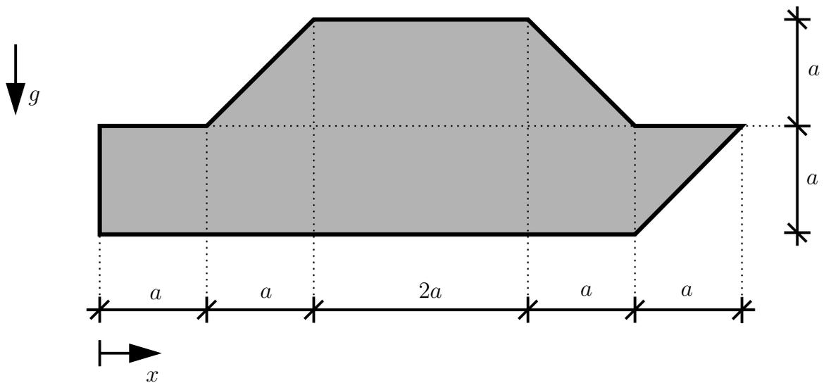
Das Modell eines Bootes soll auf einer Aufstellvorrichtung ausbalanciert werden. Berechnen Sie den Schwerpunkt  $x_S$  des Modellbootes unter der Annahme, dass das Gewicht gleichmäßig über den grau hinterlegten Bereich verteilt ist.
