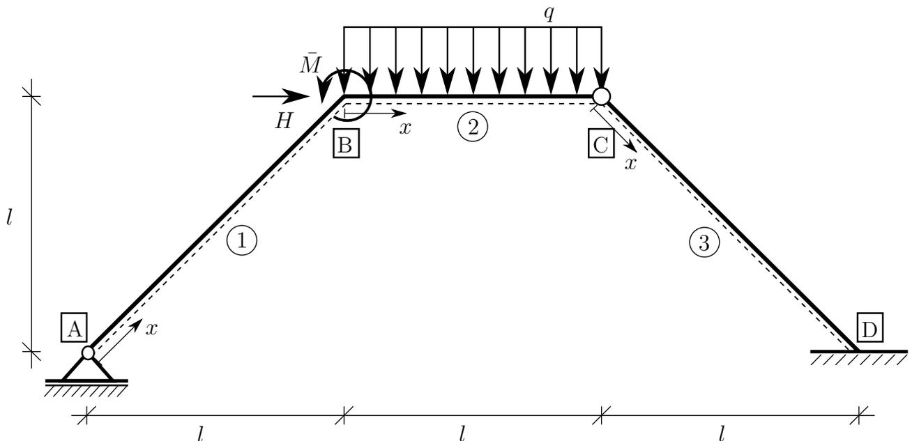
Der dargestellte Rahmen ist im Abschnitt ② mit einer konstanten Streckenlast  $q$  und im Knoten  $\text{B}$  mit einer Einzelkraft  $H = \frac{1}{2}ql$  sowie einem Einzelmoment  $\bar{M} = \frac{1}{2}ql^2$  belastet.
